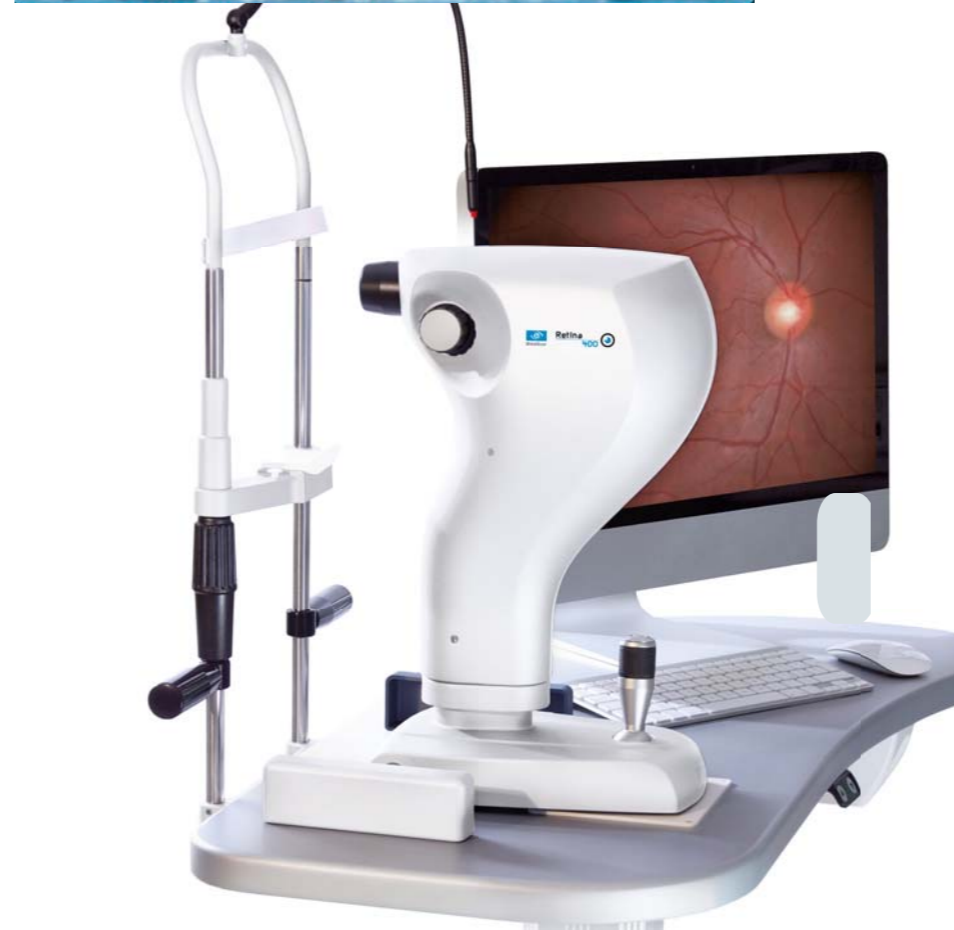
FUNZIONE MOSAICO Grazie alla modalità di acquisizione manuale, è possibile acquisire immagini relative a differenti zone retiniche con la possibilità di ottenere una visione complessiva grazie alla funzionalità MOSAICO.
